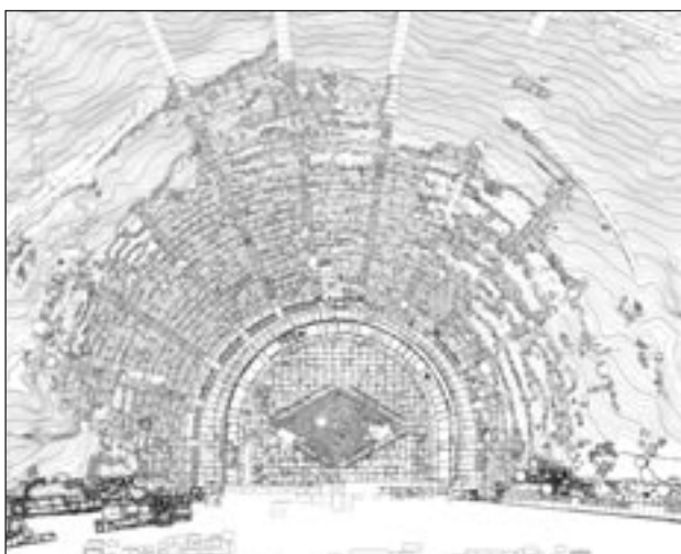
Κάτοψη του σωζόμενου τμήματος του κοίλου του Διονυσιακού Θεάτρου (Σύνθεση επιμέρους αποτυπώσεων W. Wurster - Κ. Καζαμιάκη, Μ. Κορρέ και άλλων μελετητών Επιτροπής Διονυσιακού Θεάτρου - Α' ΕΠΚΑ).
