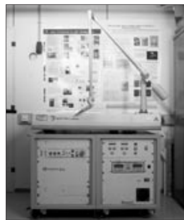
Εικ. 1: Φορητή συσκευή Φασματοσκοπίας Πλάσματος Λέιζερ για στοιχειακή ανάλυση Εικ. 2: Καινοτόμο σύστημα Λέιζερ, ικανό να εκπέμπει σε δύο μήκη κύματος ταυτόχρονα. Χρησιμοποιήθηκε για τον καθαρισμό της Δυτικής Ζωφόρου του Παρθενώνα
