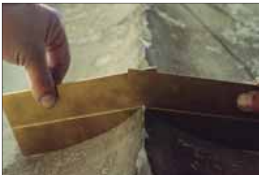
Εικ. 22. Έλεγχος της διατομής των ραβδώσεων με ορειχάλκινο τύπο διαμορφωμένο με τη βοήθεια ηλεκτρονικού υπολογιστή.
